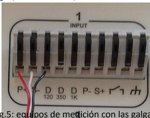
Fig.5: equipos de medición con las galgas conectadas
