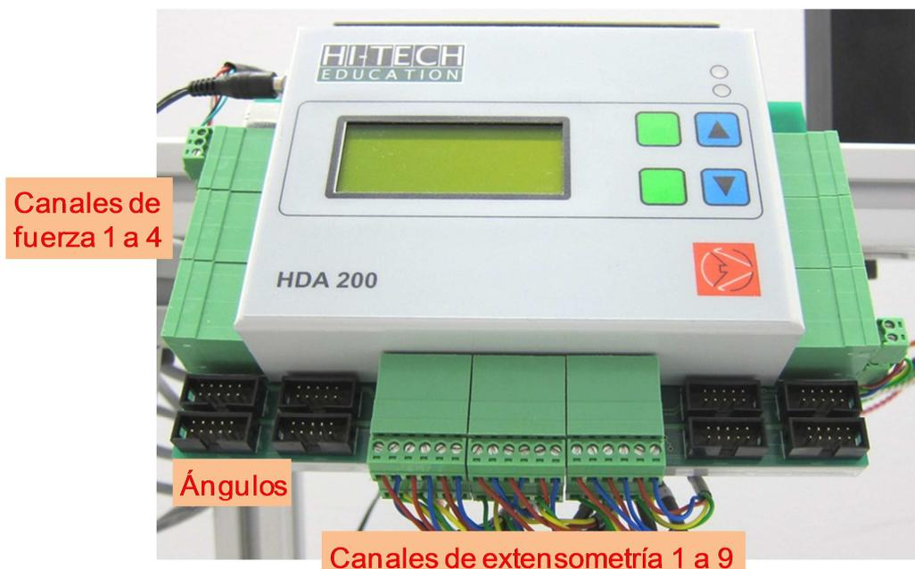
Figura 5. Interface HDA200 que será utilizada en el ensayo para la lectura de deformaciones.
