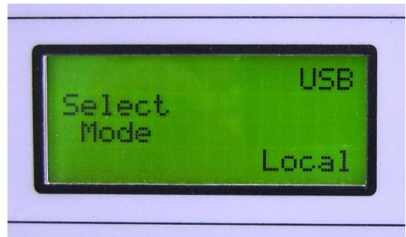
Seleccionar Local para la adquisición de datos desde los bloques de conectores.
