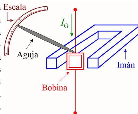
Figura 9: Esquema de un galvanómetro de bobina móvil
