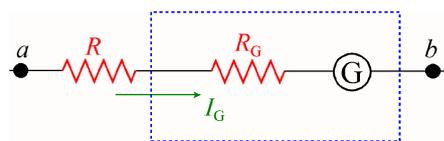
Figura 11: Voltímetro
