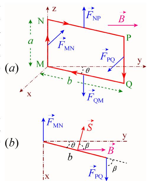
Figura 5: (a) Espira de corriente en un campo magnético uniforme. (b) Vista de la espira desde el eje  $Z$ .
