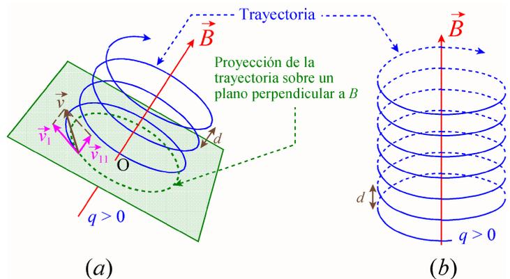
Figura 2: (a) Esquema de la composición de los dos movimientos:  $v_1$  gira en torno al punto O, en tanto que  $v_{11}$  hace que la carga avance en la dirección de  $B$ . (b) Trayectoria seguida por una carga positiva.
