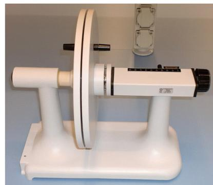
Figura 2: Condensador plano
