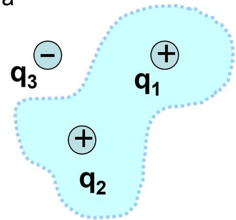
La Ley de Gauss es una herramienta muy potente para el cálculo del flujo eléctrico y, sobre todo, para el cálculo de intensidades de campo cuando las cargas que lo crean tienen un alto grado de simetría.
