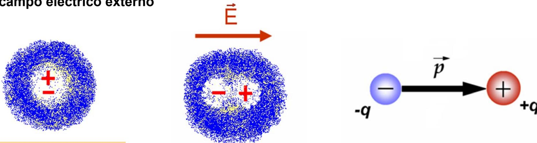
La nube negativa de electrones de un átomo normalmente está centrada sobre su núcleo positivo
