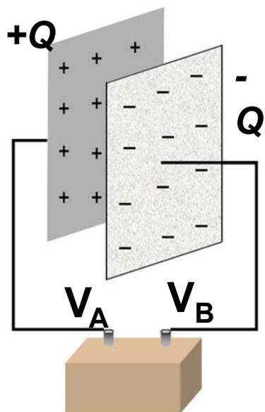
Un condensador cargado es distinto de uno descargado debido a la carga separada en las placas y al campo eléctrico entre ellas
