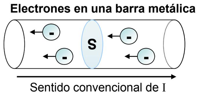
**INTENSIDAD DE CORRIENTE:** Carga que atraviesa la sección recta de un conductor en la unidad de tiempo
