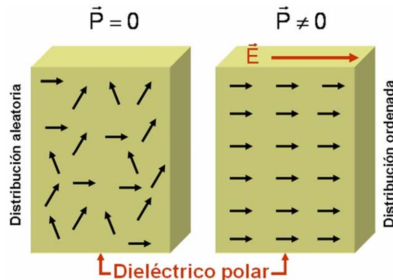
Cada molécula se transforma en un pequeño dipolo orientado en la misma dirección que el campo eléctrico
