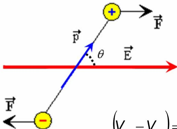
Muchos átomos y moléculas neutros se comportan como dipolos cuando se someten a un campo eléctrico externo
