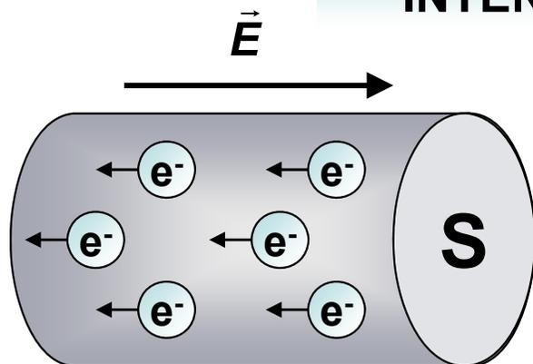
La corriente eléctrica en un alambre de metal consiste en electrones en movimiento
