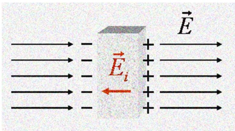
1. El campo eléctrico es CERO en cualquier punto del interior del conductor.
