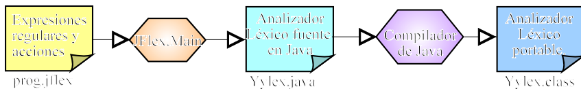
Figure 5 Obtención de un programa portable en Java a partir de una especificación JFlex
